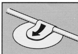
④タブ接着面にチューブを置き、タブを折り返して接着面同士をしっかりと貼り合わせて下さい。
