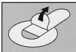
③タブ接着面のシールを剥がして下さい。
