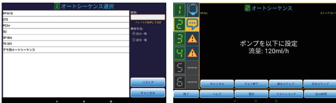
オートシーケンステストは、ユーザがテスト手順を自由に設定でき、タブレット画面に表示させるテスト手順文章の編集も可能です。オートシーケンステストの設定を行うことにより、どなたでも簡単に手順に沿ったテストを行えます。
